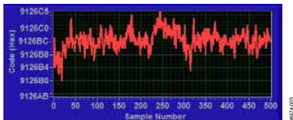
图3：500次采样所测得的输出码，体现出噪声的影响
