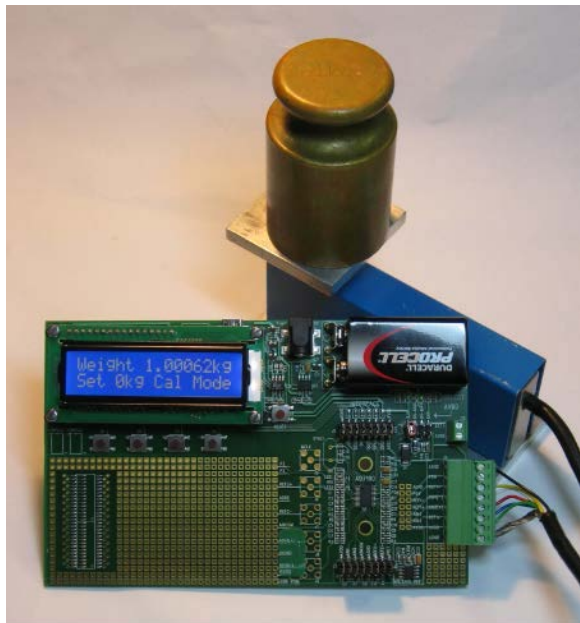
图2：采用AD7192的电子秤系统
