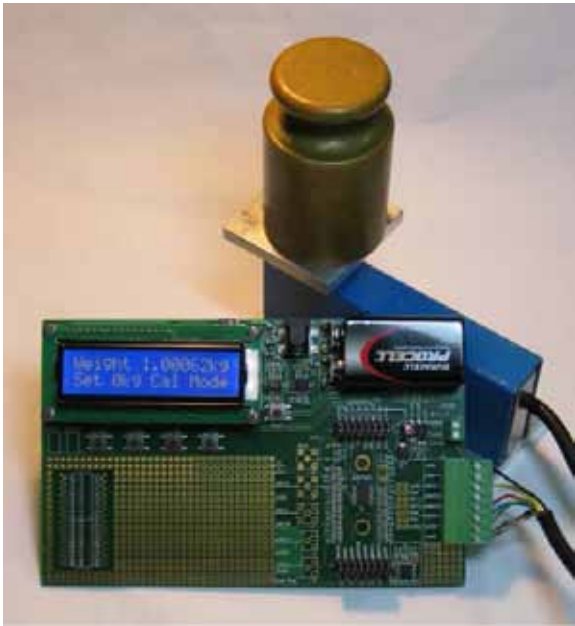
图2. 采用AD7191的电子秤系统
