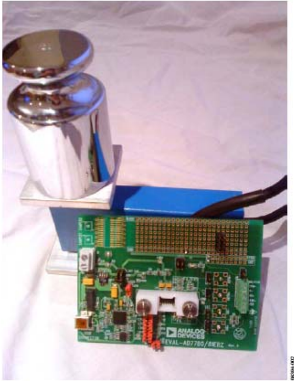
图2.采用AD7780的电子秤系统设置
