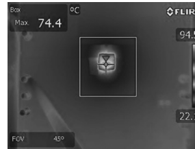
图 5： V_{IN} = 5V 、 V_{OUT} = 3.3V/5A 、 T_A = 25^\circ C 的热性能
