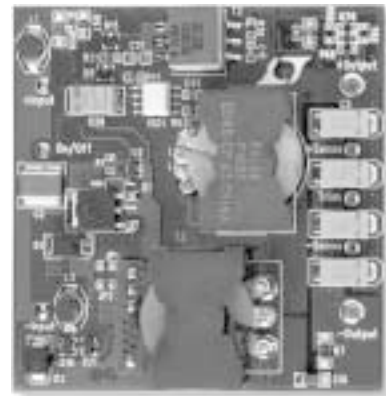
图 1：半砖外形尺寸的3.3V/20A电源
