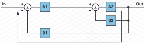
图10. 复合放大器反馈环路。
