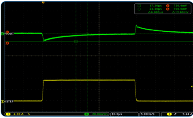
图7. MAXQ™ Power转换器的瞬态响应示例
