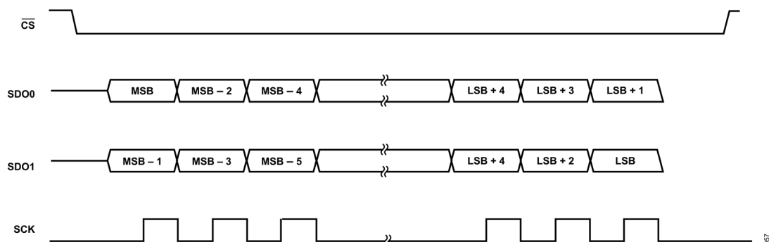
図 109. 2 レーン・モード、SDR のタイミング図
