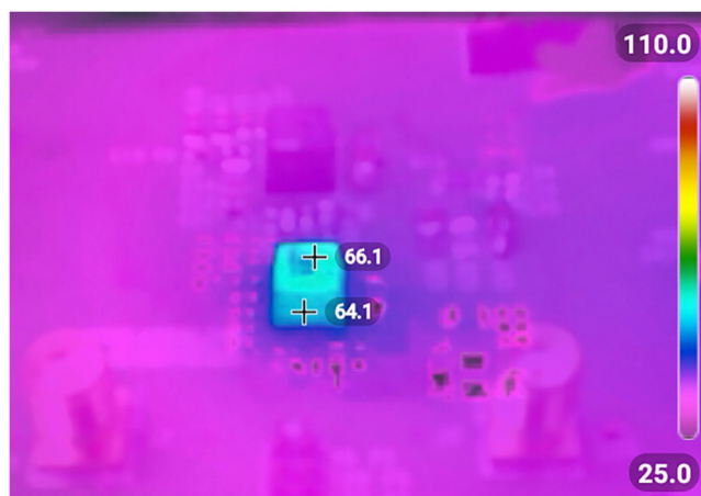
図7. 12V IN 、1V 12A出力、空気流なし条件での熱画像
