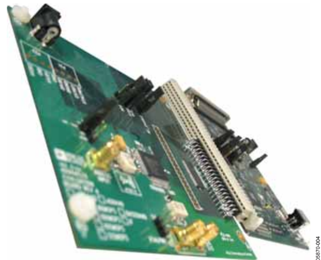
図 4. シングルチャンネル ADC
