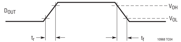
D OUT の立上り時間 t_r と立下り時間 t_f の電圧波形
