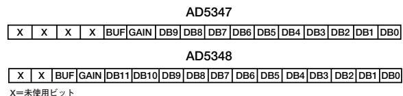
図40. GAINとBUFのデータを16ビット・バスに置いてワード・ロードするためのAD5347/AD5348のデータ・フォーマット
