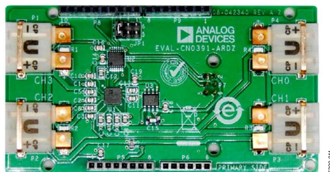
図 11. EVAL-CN0391-ARDZ ボードの写真
