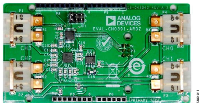
図 11. EVAL-CN0391-ARDZ ボードの写真
