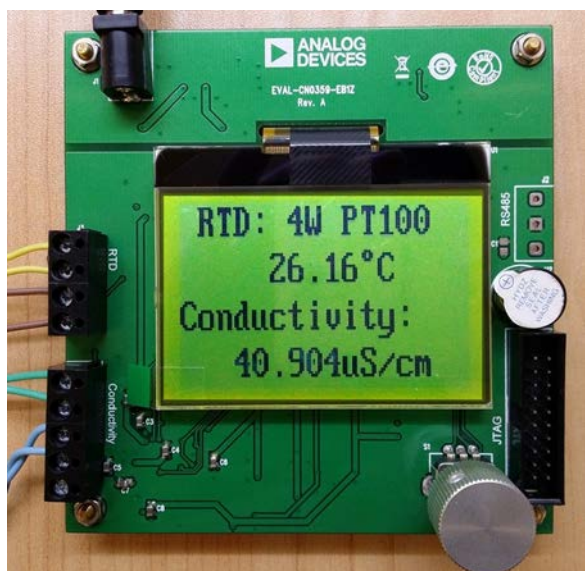
図 12. EVAL-CN0359-EB1Z ボード： ディスプレイは測定モードのホーム・スクリーン
