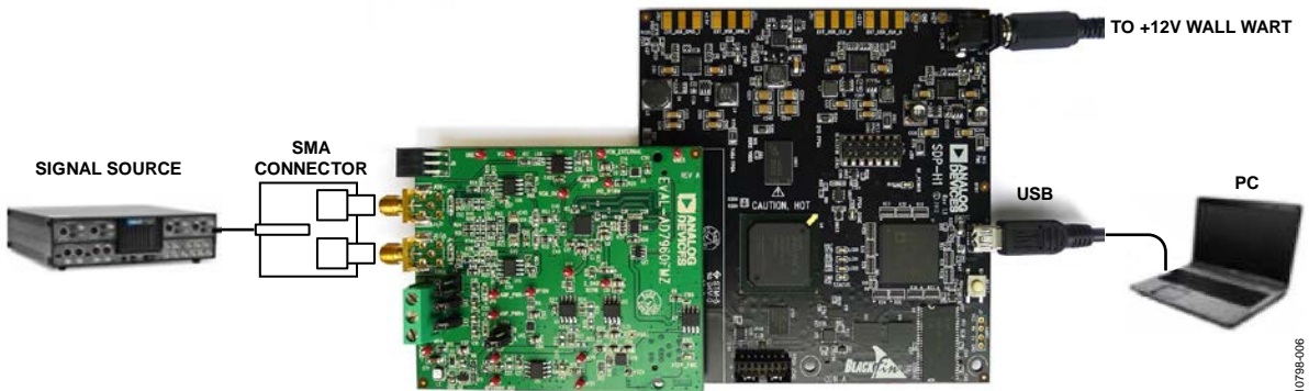
図 6. EVAL-SDP-CH1Z ボードに接続された EVAL-AD7960FMCZ ボード
