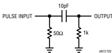
**Figure 20. Probe Test Circuit**
