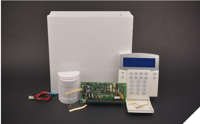
图1. 传统入侵检测系统解决方案部署硬件包。
