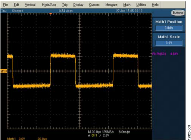
图9. EVAL-CN0373-EB1Z板上RS-485端口的Y-Z数学波形
