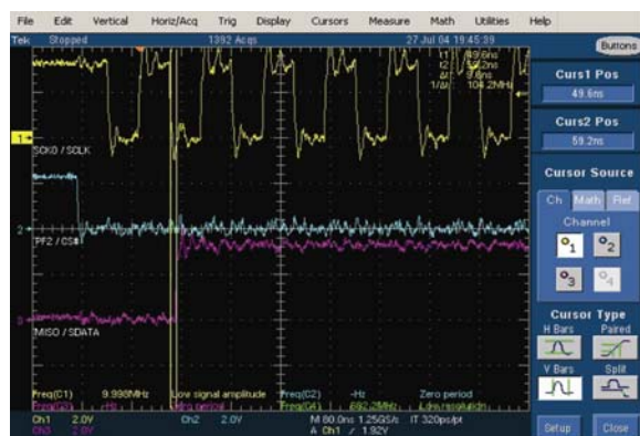
图4 CPHASE=0, CPOL=1内核访问模式 – AD7276 的保持时间
