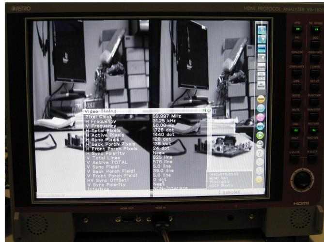
图15. 视频时序下的并排576p图像
