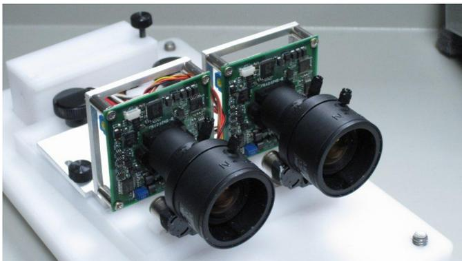
图1. 支架上的两台摄像机(已针对立体视觉对齐)
