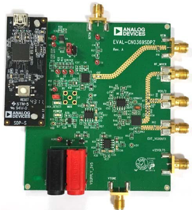
图10. EVAL-CN0369-SDPZ PCB照片
