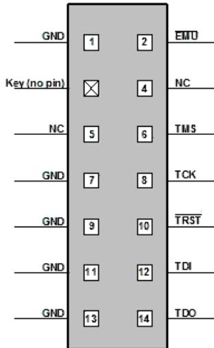
Figure 1-3. J1 Pinout
